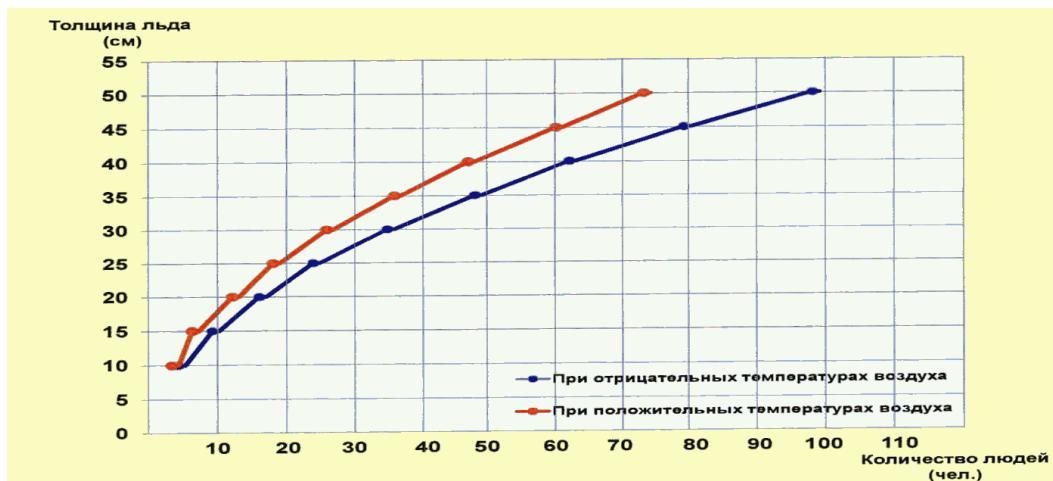
Рис. 1 График зависимости максимального допустимого количества людей на льду площадью 100 м<sup>2</sup> (10 x 10) от толщины льда
